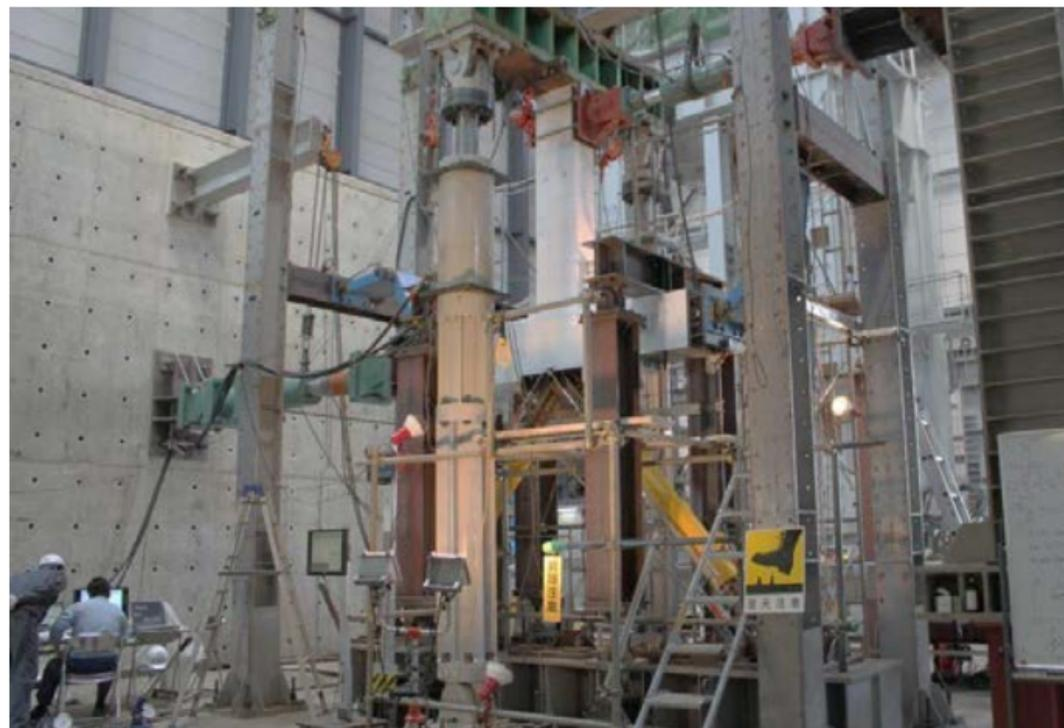
写真1 制振ダンパーを組み込んだ RC 部分架構の実験
